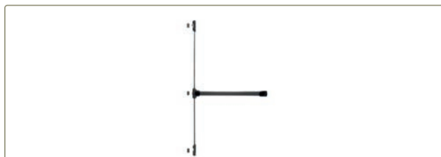
(Ferragem ambidestra com 3 pontos de fecho superior e inferior e lateral) Largura mínima da porta: 800mm Altura máxima da porta: 1240mm
