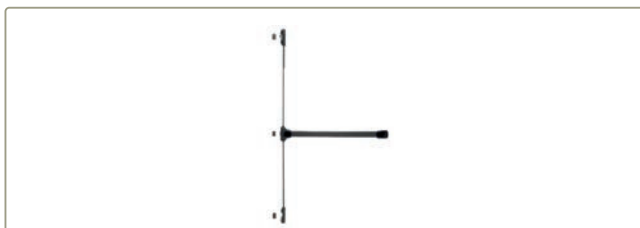
(Ferragem ambidestra com ponto de fecho superior e inferior) Largura máxima da porta: 2450mm Altura máxima da porta: 1240mm
